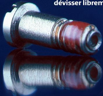
Une vis avec un revêtement **NteSecur®** a besoin, par rapport à une autre vis (non-revêtue ou collée), d'un couple de dévissage plus grand, et a les mêmes caractéristiques au déblocage, qu'une vis non-revêtue, non-collée, mais dispose d'un couple résiduel qui l'empêche de se dévisser facilement (sous vibration, p. Ex.).
